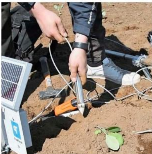
Anturit sijoitettiin ohjeiden mukaan 8 ja 20 cm syvyyteen.
