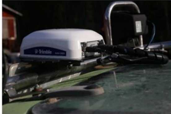
Trimble Nav-900 asennettiin ohjaamon katon reunoja kiertävään rosteriseen valotelineeseen.
